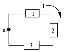
$$V_a + \Delta V_1 + \Delta V_2 + \Delta V_3 \dots = V_a$$
