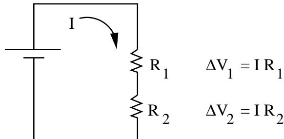
If  $R_1 > R_2$ ,  $\Delta V_1 > \Delta V_2$ .
