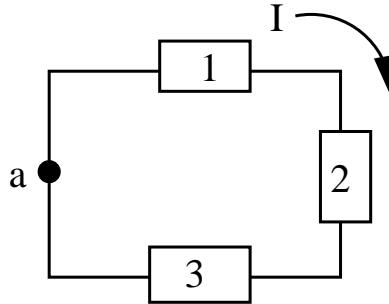
$$V_a + \Delta V_1 + \Delta V_2 + \Delta V_3 \dots = V_a$$
